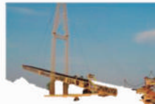
RADIAL TIPO MASTIL
